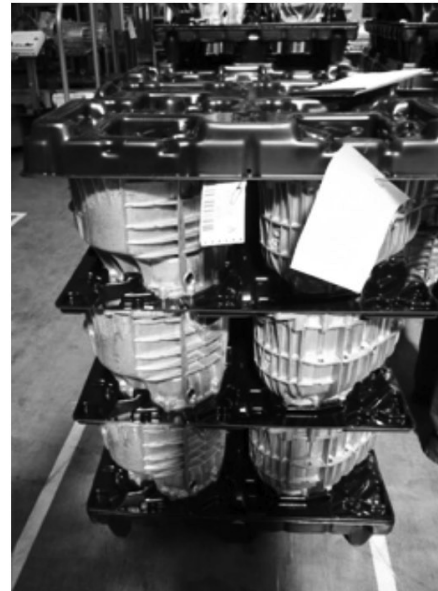
Abbildung 1: Eine einheitliche Sortierung der Getriebegehäuse sollte ihre Entnahme mittels Lastenmanipulatoren vereinfachen
