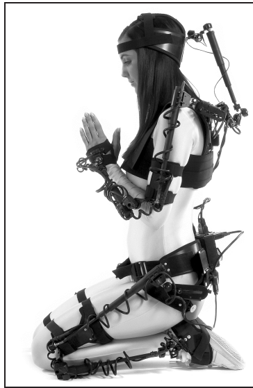
Abbildung 1: Motion-Capturing-System mit Exoskelett (Bild: Animazoo)
