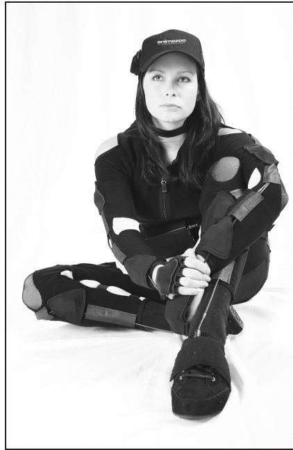
Abbildung 2: Motion-Capturing-System mit körperfixierten Sensoren (Bild: Animazoo)
