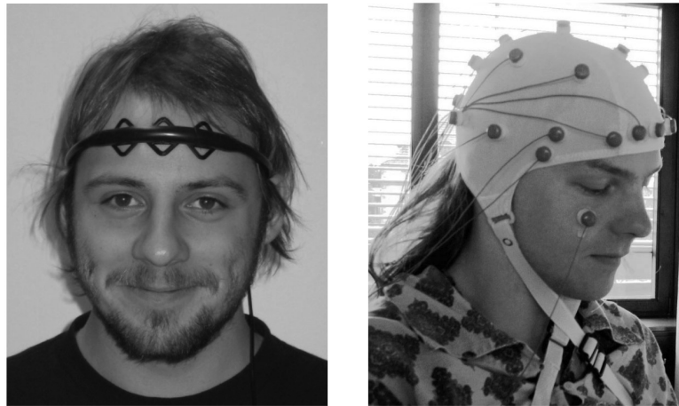
Abbildung 1: Untersuchte Spielesteuerung mit drei Elektroden (links) und konventionelle EEG-Erfassung mit 32 Elektroden (rechts)
