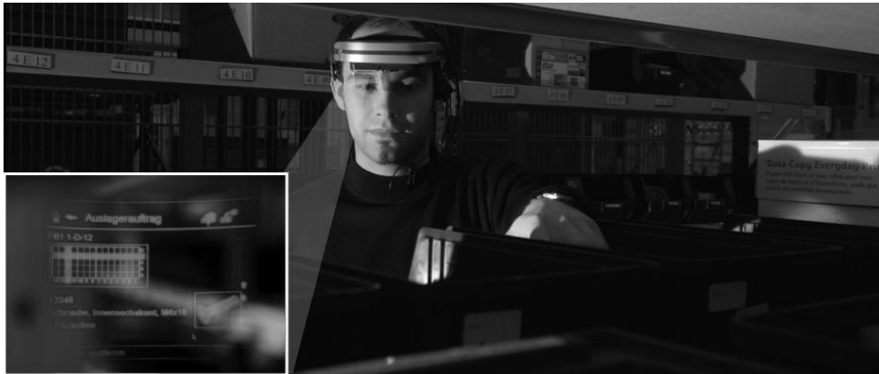
Abbildung 1: Verwendetes Pick-by-Vision-System mit möglicher Visualisierung (kleines Bild)
