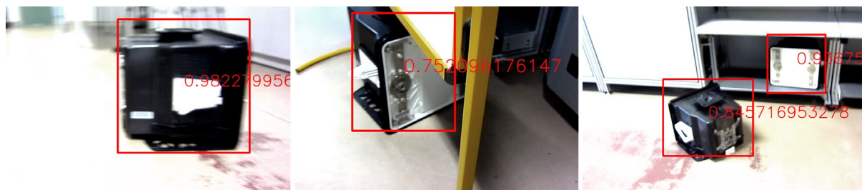
Abbildung 4: Detektionen von FOUPs in exemplarischen Auszügen von Videoaufnahmen zu den jeweiligen Szenarien SNG (li.), OCC (mi.) und DBL (re.). Die roten Markierungen umfassen den detektierten Bildbereich. Innerhalb der Markierung ist der dazugehörige Konfidenzwert abgebildet.
