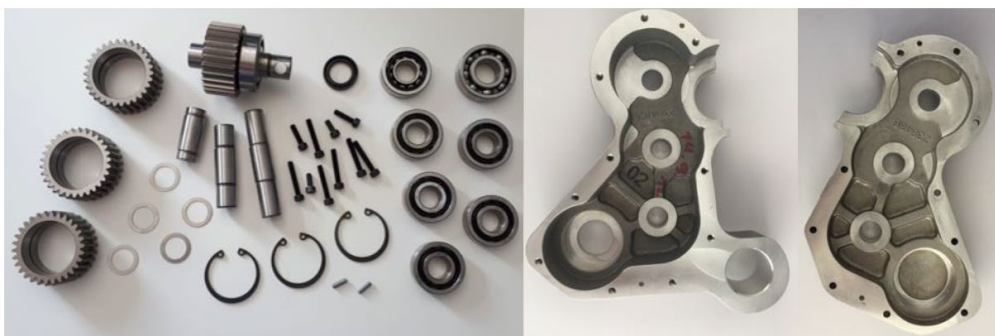
Abbildung 1: Einzelteile der betrachteten Getriebemontage
