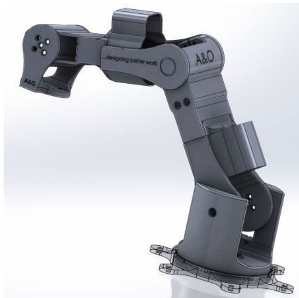
Abbildung 1: Am FG A&O entwickelter Roboterarm mit sieben Freiheitsgraden
