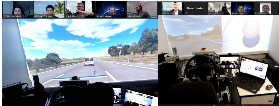
Abbildung 2: Hybride Mensch-Technik Exploration von teil- und hochautomatisierten Übergaben im DFG-Schwerpunktprogramm ColnCar. Rechts: Demonstration des Aufbaus mit virtuellem Eingabegerät
