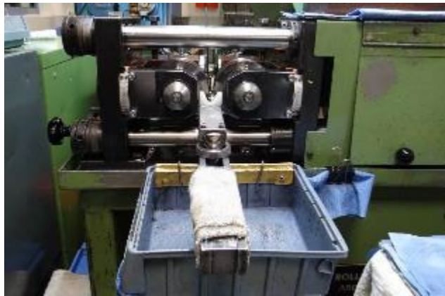
Abbildung 1: Fotoaufnahme der Gewinderollmaschine (Ines Faltin, Knowledge Symphony GmbH)
