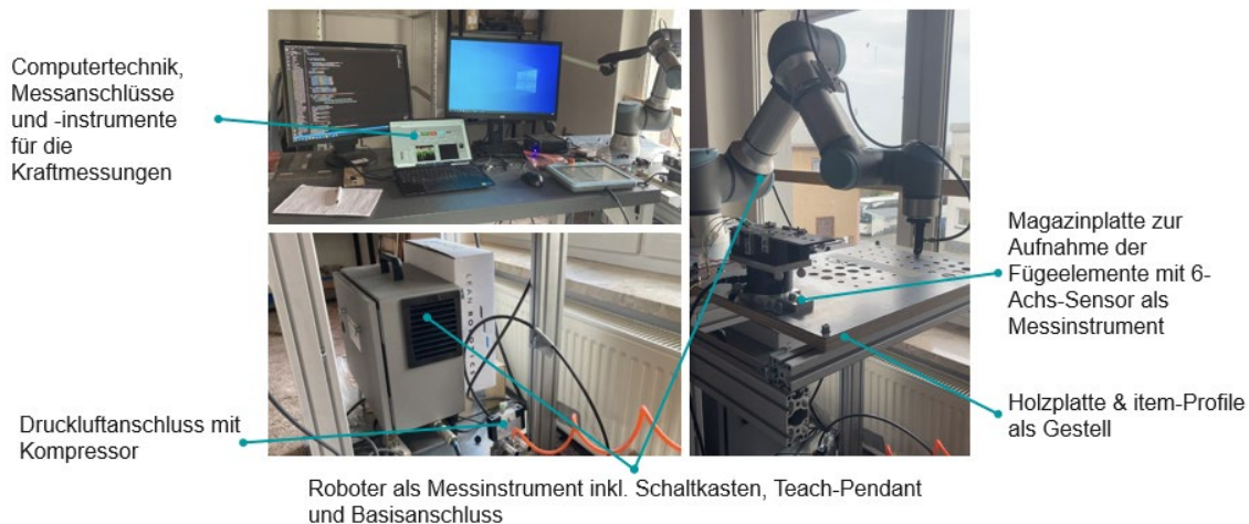
Abbildung 1: Roboterkraftmessstand zur Erfassung von Fügekräften
