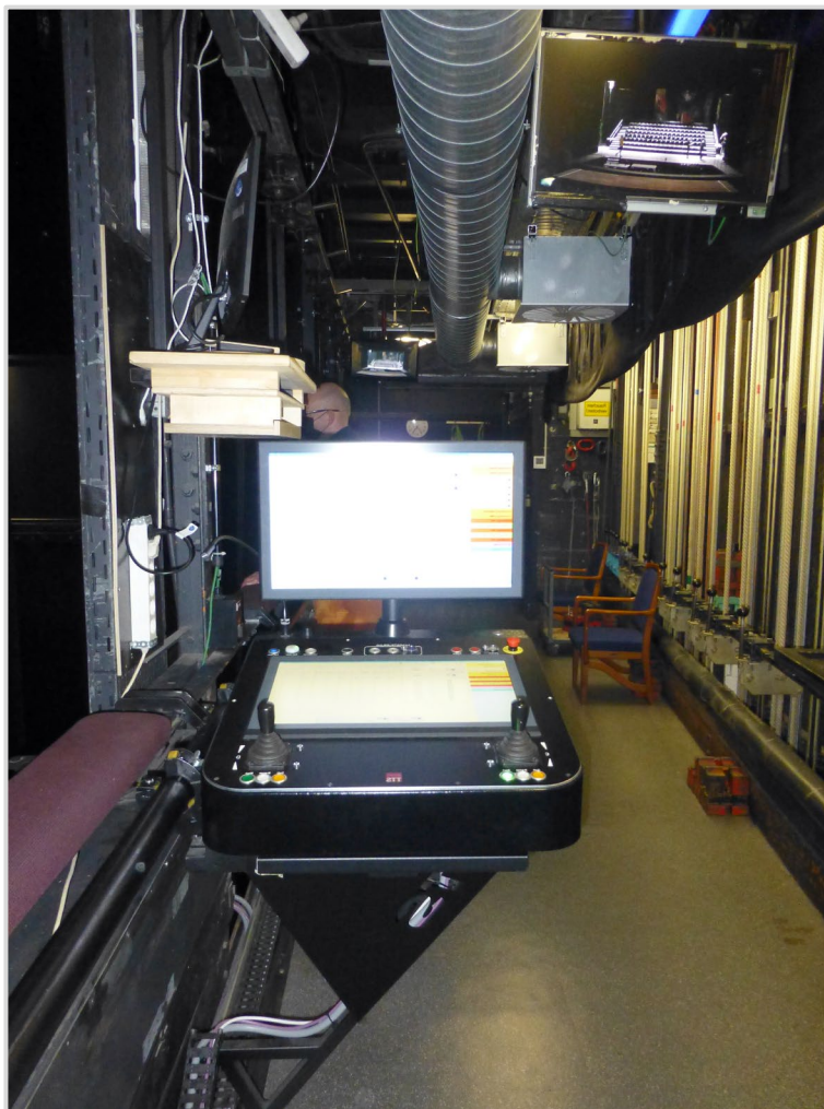
Abbildung 1: Auf der Arbeitsgalerie an Laufschiene montiertes Pult zum Fahren der Ober- und Untermaschinerie der Oper Bonn [Foto: Peter Nickel]
