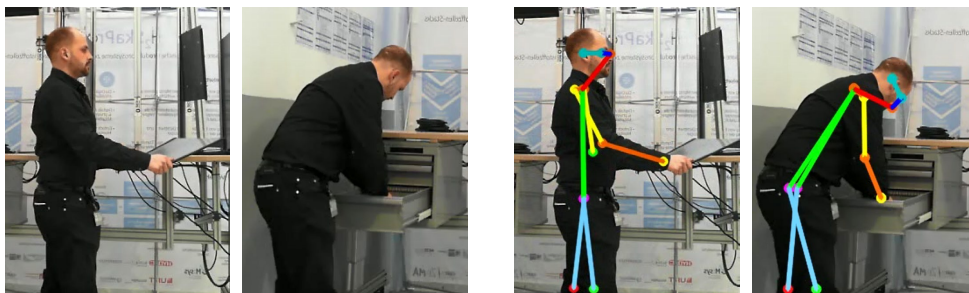
Abbildung 3: Proof-of-Concept zur Gelenkdetektierbarkeit (rechts) aus 2D-Kamerabildern (links)
