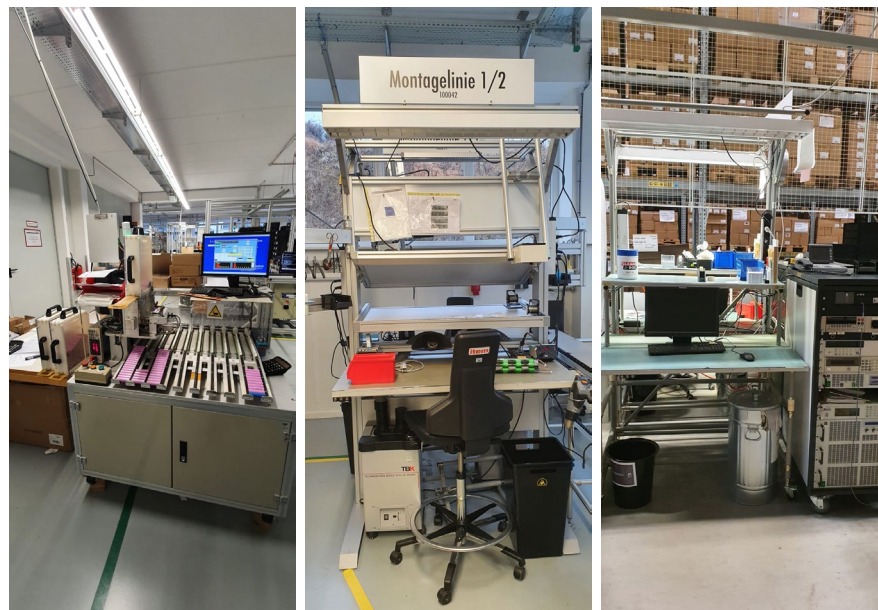
Abbildung 1: Arbeitsplätze Zellenselektion (1), Montagelinie (2), Prüf- und Packstation (3)
