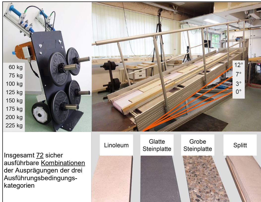
Abbildung 1: Ausprägungen der drei Ausführungsbedingungskategorien: Lastgewicht (oben links), Wegneigung (oben rechts) und Untergrundtyp (unten).
