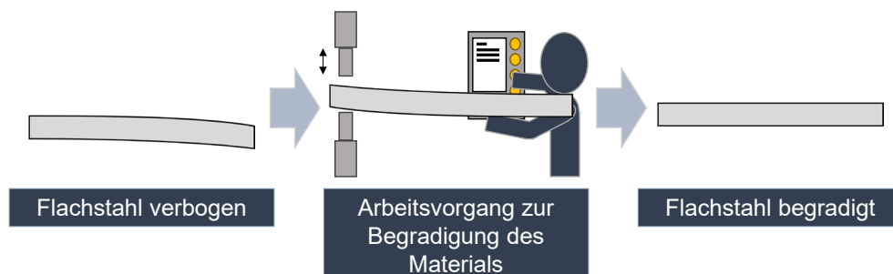
Abbildung 1: Vereinfachte, bildliche Darstellung des betrieblichen Anwendungsfalls „Richten von Flachstahl“ bei der Firma ESM (Ottersböck et al. 2023)
