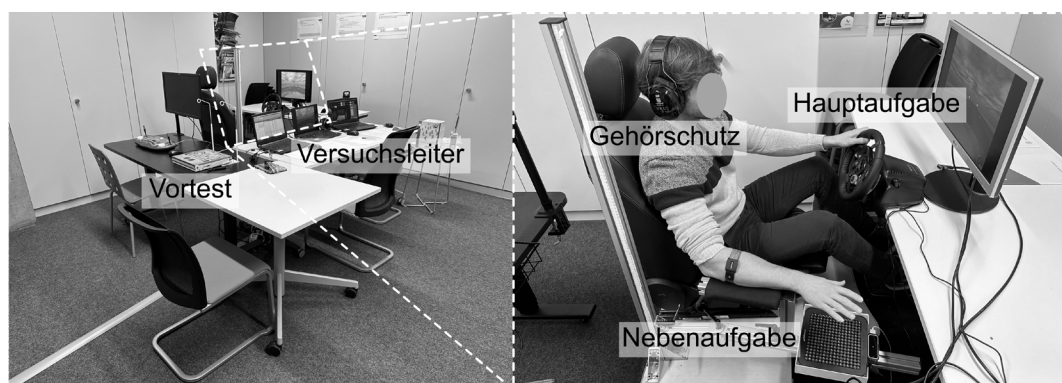
Abbildung 1: Versuchsaufbau (links) bestehend aus dem Bereich des Vortests, dem Sitz des Versuchsleiters und dem Aufbau des Hauptversuchs (rechts)
