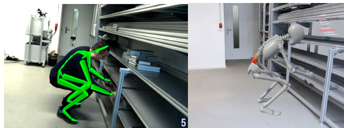
Abbildung 1: Die mit Motion Capture erfassten Körperbewegungen werden zur Analyse in die Virtual-Reality Simulation übertragen und für eine intuitive Bewertung durch visuelle Feedbackmechanismen erfahrbar gemacht. Für tiefergehende Analysen können ergänzende Daten, wie zurückgelegte Laufwege, Kompressionsbelastungen, an RULA (Rapid Upper Limb Assessment) angelegte Scorings oder empfohlene Bewegungsmuster nach Bedarf eingeblendet werden. Darstellung aus dem Kompetenzzentrum AkzentE4.0.
