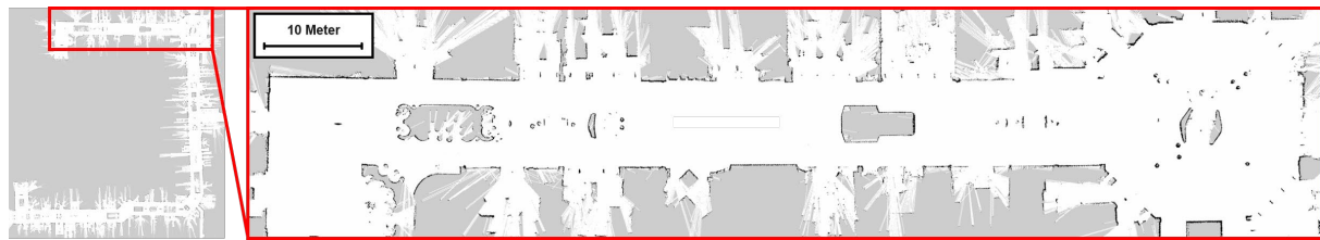
Abbildung 2: Links: Vom Roboter aufgezeichneter Grundriss des u-förmigen Ganges des Einkaufszentrums; Rechts: Der vom Roboter befahrene Gang, weiße Flächen sind vom Roboter befahrbar, schwarze Punkte stellen vom Roboter gemessene Hindernisse dar und graue Flächen konnten nicht gemessen werden.
