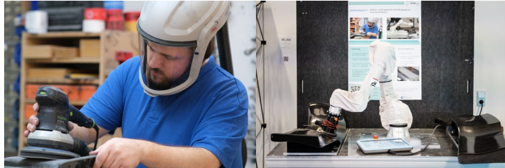
Abbildung 2: Darstellung des händischen Schleifprozesses unter schwierigen ergonomischen Bedingungen und PSA (links); Darstellung des (teil)automatisierten Schleifprozesses mit Unterstützung des Roboters (rechts); Darstellung aus dem Kompetenzzentrum WIRKsam.
