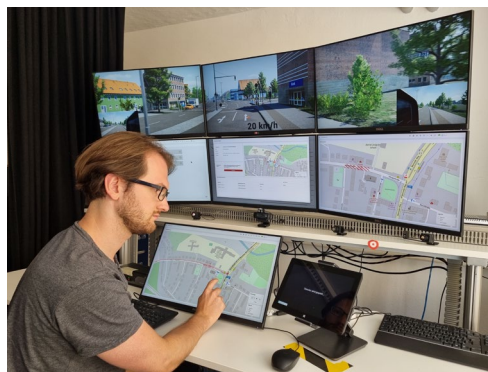
Abbildung 1: Studienaufbau bestehend aus einem prototypischen Arbeitsplatz zur Fernassistenz, einem Tablet-Computer zur Präsentation der n-back -Aufgaben sowie Sensorik zur Erfassung von Blickverhalten, Pupillenverhalten, Hautleitfähigkeit, Herzrate und Herzratenvariabilität
