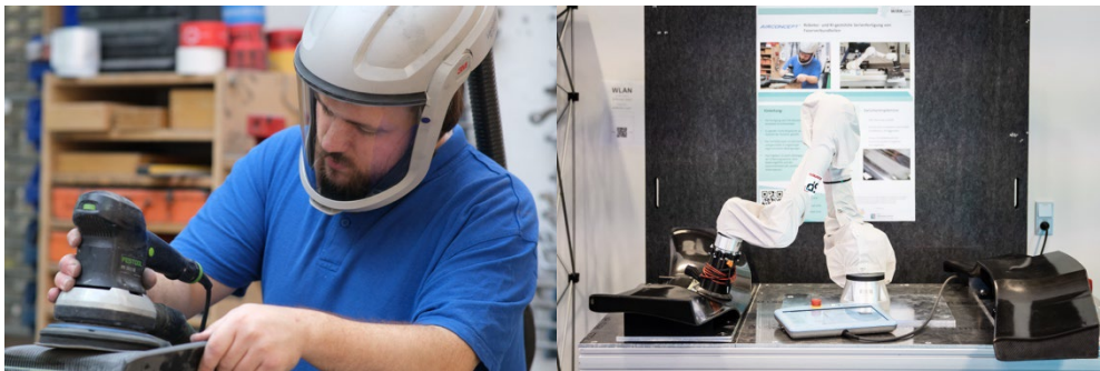
Abbildung 1: Auf der linken Seite der Abbildung bearbeitet der erfahrene Mitarbeitende die Oberfläche eines CFK-Heckflügels mit einem Exzentrerschleifer. Die rechte Seite der Abbildung zeigt den Prototyp eines Schleifsystems, das die Mitarbeitenden durch Übernahme großer Teile des Schleifprozesses entlasten soll.
