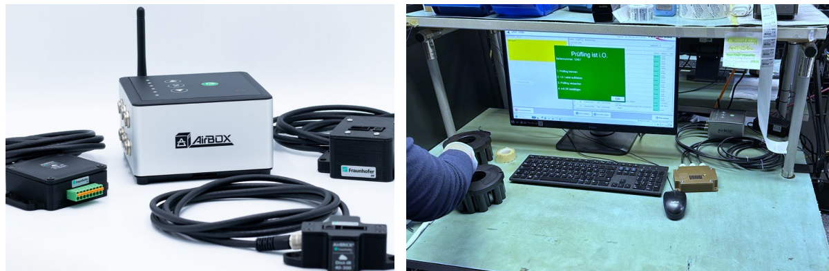
Abbildung 2: AirBOX des Fraunhofer IFF mit zugehörigen Sensoren (links) und AirBOX installiert am Verpackarbeitsplatz beim Anwendungspartner Ansmann AG (rechts).
