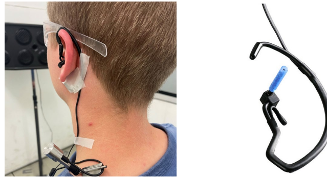
Abbildung 2: Proband mit Schutzbrille, eingesetztem Gehörgangsmikrofon und am Shirt befestigten Außenmikrofon (links) sowie das mit einem blauen Silikonschlauch geschützte Gehörgangsmikrofon mit Tragebügel (rechts)
