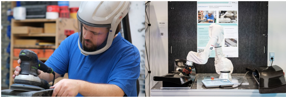
Abbildung 1: Auf der linken Seite der Abbildung bearbeitet ein erfahrener Mitarbeiter die Oberfläche eines CFK-Heckflügels mit einem Exzentrerschleifer. Die rechte Seite der Abbildung zeigt den Prototyp eines Schleifsystems, das die Mitarbeitenden durch Übernahme großer Teile des Schleifprozesses entlasten soll.
