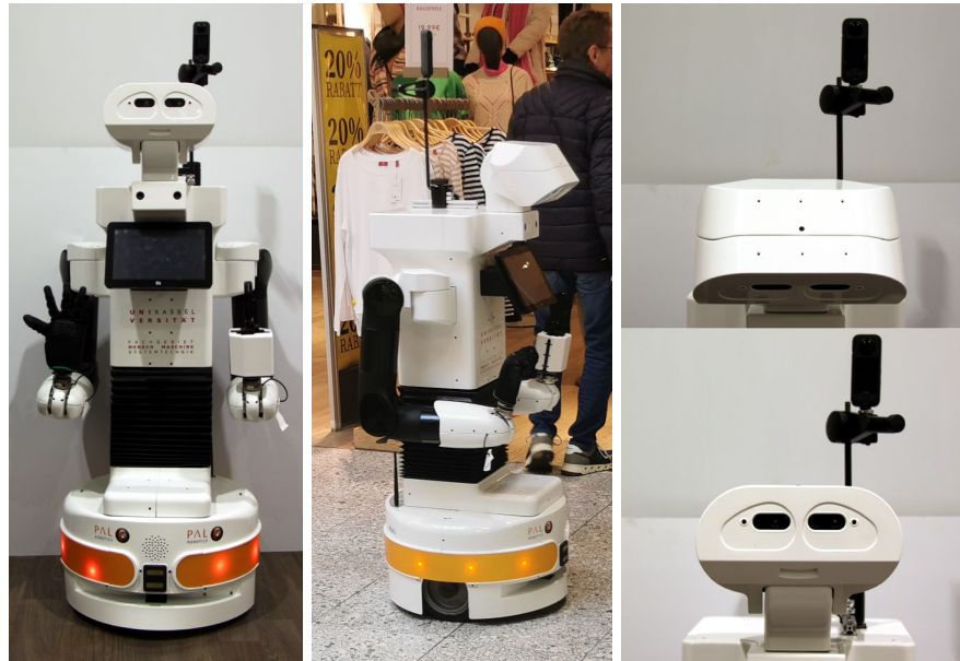
Abbildung 1: Links: TIAGo++ mit oberhalb des Kopfes montierter 360°-Kamera im Labor; Mitte: TIAGo++ im Einkaufszentrum; Rechts: Vergleich der Frontansicht mit gesenktem und nach vorne gerichtetem Kopf
