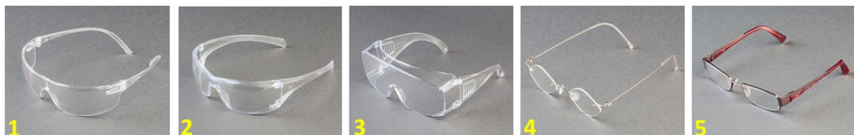
Abbildung 1: Im Versuch eingesetzte Schutzbrillen (Brille 1 bis Brille 3) und Korrekturbrillen (Brille 4 und 5)
