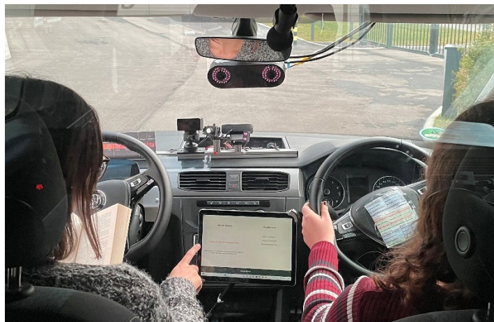
Abbildung 1: Setup im Versuchsfahrzeug während der Fahrt im Realverkehr, mit der Versuchsperson auf dem Platz links vorne, hier beim Lesen eines Buches, und der Fahrerin rechts vorne.
