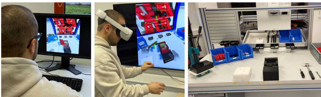
Abbildung 1: Video-Gruppe beim Betrachten eines Montageschrittes inklusive Zusatzinformationen (links); VR-Gruppe mit dem HMD und Übertragung des Blickfeldes auf externen Monitor (mittig); Montagearbeitsplatz mit Handhebelpresse, Montagevorrichtungen und Bereitstellungskisten (rechts)
