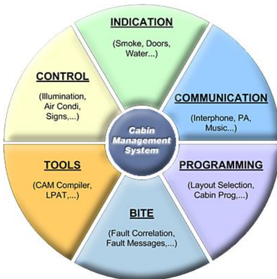
Abbildung 1: Funktionsgruppen des Kabinen-Management-Systems
