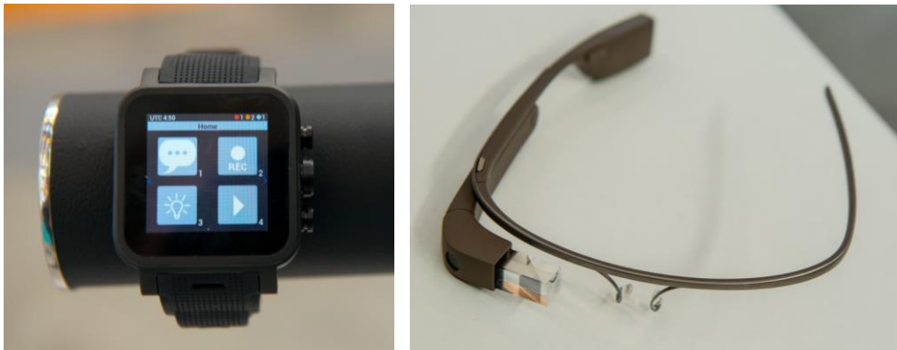
Abbildung 9: Wearable Devices für die mobile Steuerung des Kabinen-Management-Systems (links Simvalley Smart Watch, rechts Google Glass).
