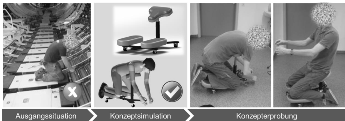
Abbildung 18: Ausgangssituation und Lösungskonzept zur Reduzierung der Kniebelastung in der Flugzeugmontage bei knienden Tätigkeiten (Einsatz universell)
