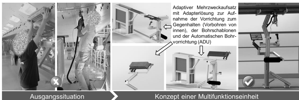
Abbildung 16: Ausgangssituation (links) und Lösungskonzept für eine Multifunktionseinheit zur Erstellung der unteren Längsnaht am Flugzeugrumpf (Mitte: Bereitstellung und Montage von Bohrschablonen. Rechts: Einsatz als teilautomatisierte Bohrvorrichtung)
