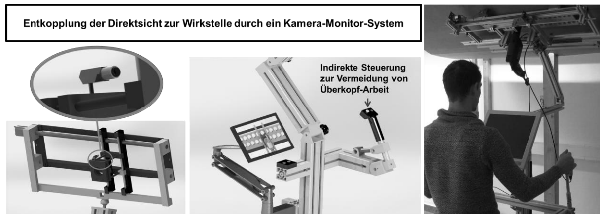
Abbildung 17: Darstellung des Wirkprinzips „Entkopplung der Direktsicht zur Wirkstelle (links) und Risikobeurteilung am Prototyp (rechts)
