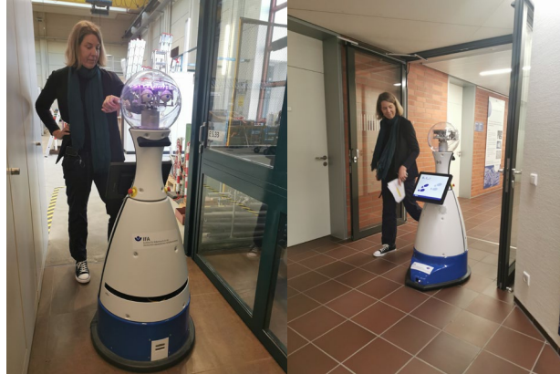
Abbildung 5/6: In beengten Verhältnissen oder bei Personenverkehr auf den Fahrweg: Stopp und/oder Bewegung mit einer Geschwindigkeit weit unter dem menschlichen Schritttempo durch den Service-Roboter
