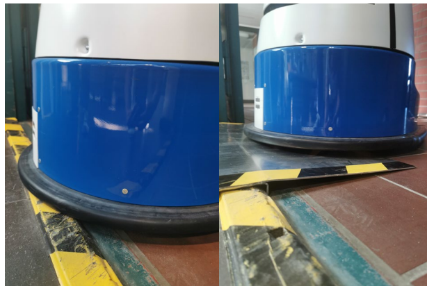
Abbildung 7: Bei Bodenunebenheiten Stopp durch den Service-Roboter; Lösung durch Einsatz einer Rampe
