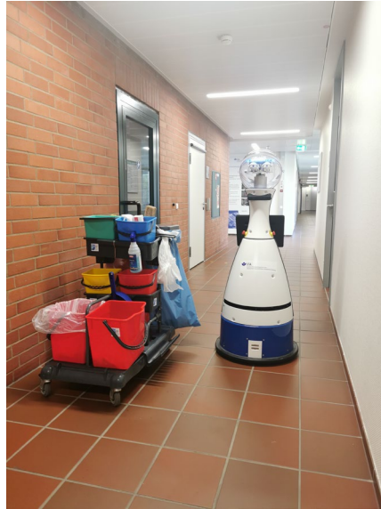
Abbildung 2: Umfahren von Hindernissen (hier: Wagen des Reinigungspersonals) durch den Service-Roboter
