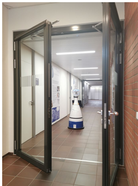
Abbildung 3: Bewegung des Service-Roboters durch eine in Fahrtrichtung öffnende, automatische Tür mit Bewegungssensor
