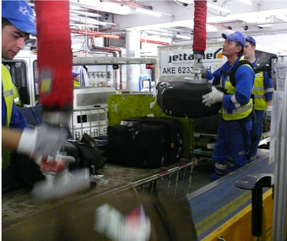
Abbildung 3: Heben und Umsetzen von Gepäckstücken mit Hilfe von Vakuumhebehilfen in der Gepäckzentrale eines Flughafens
