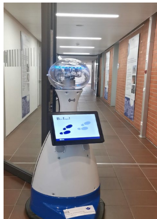
Abbildung 4: Der Service-Roboter fährt sich an einer gegen die Fahrtrichtung öffnenden, automatischen Tür mit Bewegungssensor fest.
