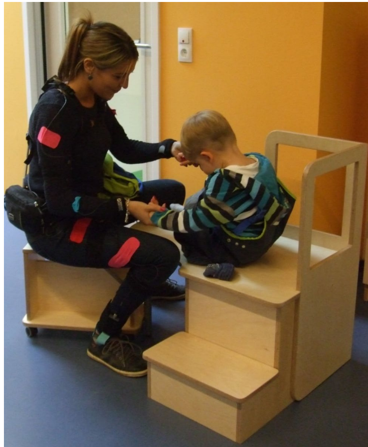
Abbildung 2: Erzieherin mit CUELA-Messsystem bei Nutzung einer entwickelten Anziehhilfe, Quelle: Unfallkasse Rheinland-Pfalz
