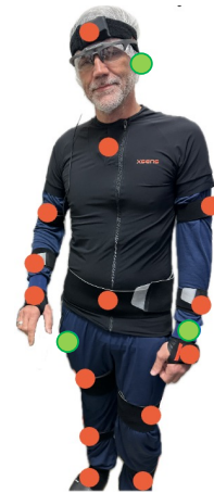
Abb. 2: Sensorplatzierung der 3 Wearables (Smartphone, Smartwatch, Kopfhörer) und der 17 Anzugsensoren
