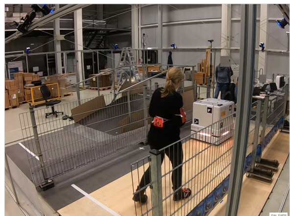
Abbildung: VP und Roboter begegnen sich im Durchgang und weichen sich menschkontrolliert aus
