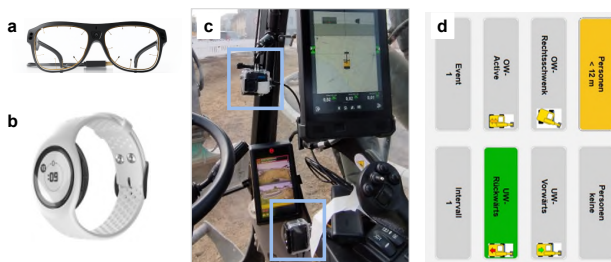
Abb. 3: (a) Eyetracker zur Blickerfassung; (b) Armband zur Erfassung psychophysiologischer Daten; (c) GoPro™-Kameras für Kontextvideos; (d) Ausschnitt der Benutzungsoberfläche des Tätigkeitsrekorders.
