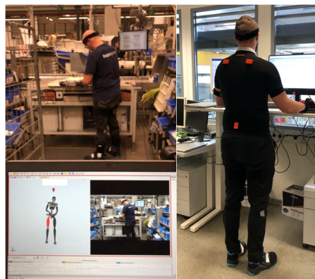
Abbildung 1: Datenaufnahme mittels inertialer Messeinheiten in Produktion und Büro.
