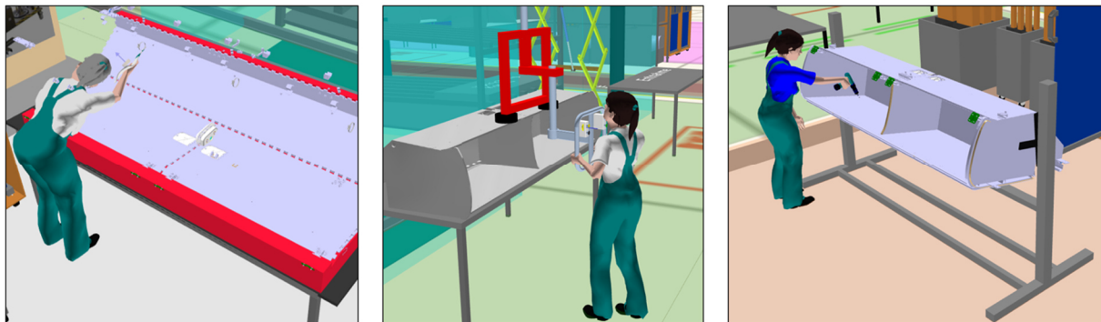
Abbildung 5: Gestaltung Arbeitsplätze für Einsatz von F05, M50 und M95; links: AP Nr.1a „Korpus kleben“ mit Vorrichtung; mittig: AP Nr.2 Trockenregal, Entnahme mit Manipulator; rechts: AP Nr.3 Montage Anbauteile mit höhenverstellbarer, drehbarer Vorrichtung
