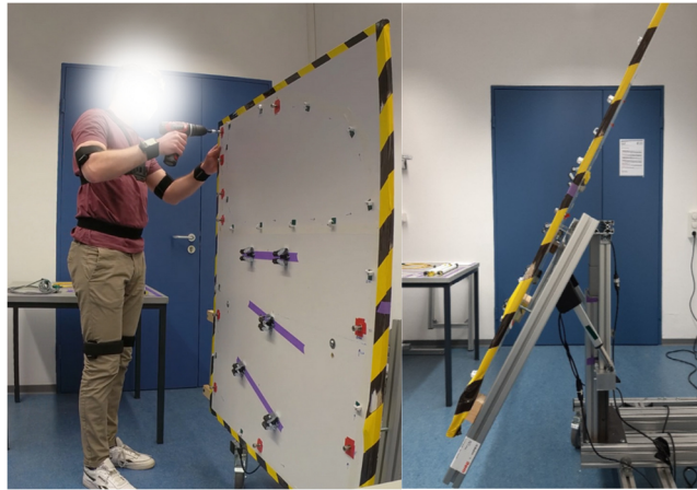
Abbildung 1: Versuchsaufbau mit einem Mockup des adaptiven Systems (rechts). An einem großflächigen Montagebrett (links) wurden manuelle Montageprozesse simuliert.
