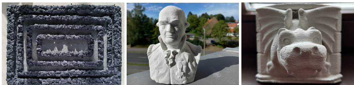
Abbildung 1: Links: gedrucktes Infill auf der Faserplatte. Mitte: Werner-Büste. Rechts: Wasserspeier.
