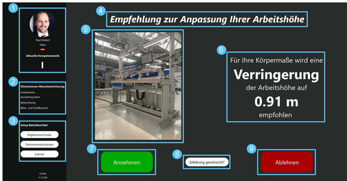
Abbildung 2: Darstellung des Aufbaus der GUI des Recommender-Systems am Beispiel einer Optimierungsempfehlung zur Anpassung der Höhe der Arbeitsfläche.
