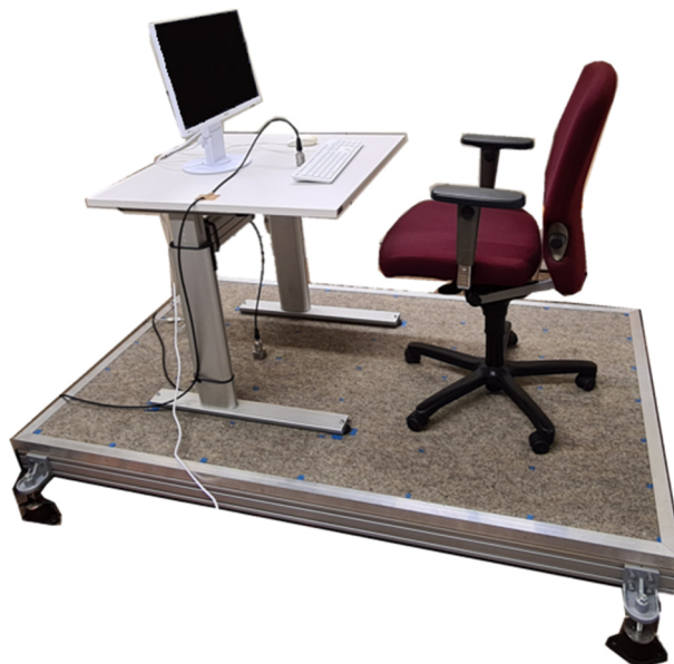
Abbildung 1: Aufgebauter Prüfstand zur Untersuchung der Wahrnehmungsschwellen an einem nachgebauten Büroarbeitsplatz im IFA.
