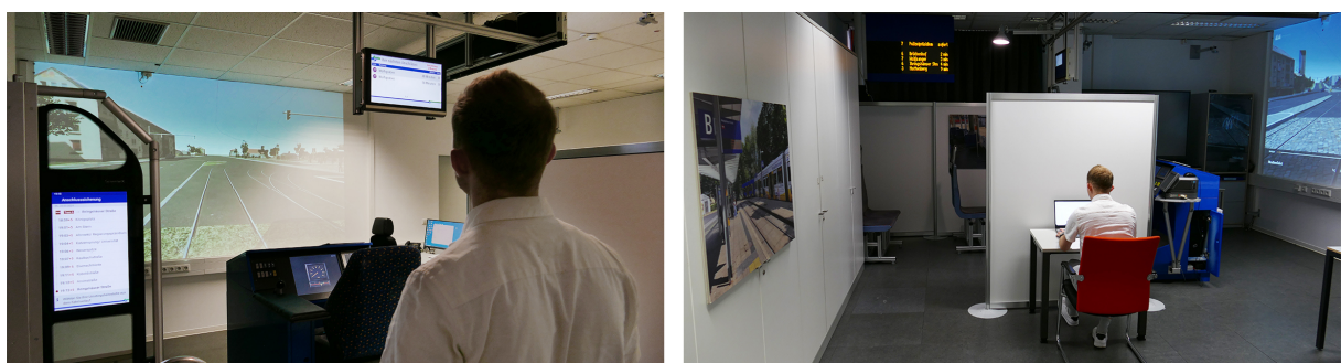
Abbildung 1: Laboraufbau mit Fahrzeugterminal, Innenanzeiger und Straßenbahnsimulator (links) und Haltestellenanzeiger, Straßenbahnsitzen und Bereich zum Ausfüllen der Fragebögen (rechts).
